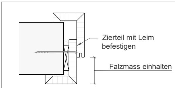
1. Zargenfalzteil in Maueröffnung stellen, höhenmässig, lotrecht, waagrecht und fluchtgerecht ausrichten und fixieren (z.B.: mit Keilen).
