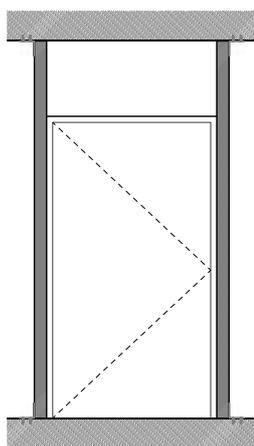
Stützen Vertikal und Riegel im Sturz
