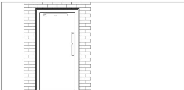
1. Holz-Umfassungszarge in Maueröffnung stellen, höhenmässig, lotrecht, waagrecht und fluchtgerecht ausrichten und fixieren (z.B.: mit Keilen).
