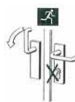
Bei Fluchttürverschlüssen darf kein Schliesszylinder mit Knauf oder Drehknopf eingebaut werden. Ausnahme: Selbstverriegelnde Schlösser der Serie 19xx und 21xx.
