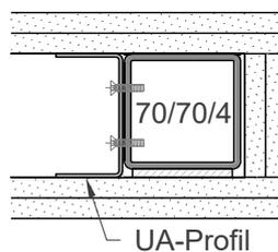
Stahlstützen 70x70x4 mm
