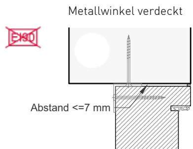
**Elementverbindung zu Verbreiterungen, Vollbau- oder Glaswänden**
