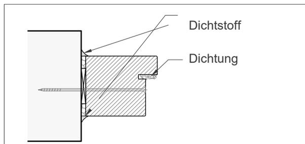
1. Blockzarge in Maueröffnung stellen, höhenmässig, lotrecht, waagrecht und fluchtgerecht ausrichten und fixieren (z.B.: mit Keilen).
