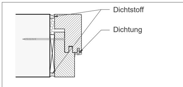
1. Blockfutterzarge in Maueröffnung stellen, höhenmässig, lotrecht, waagrecht und fluchtgerecht ausrichten und fixieren (z.B.: mit Keilen).
