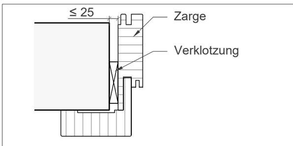
2. Befestigungspunkte (siehe Befestigungspunkte Zarge) mit Holz- oder Holzwerkstoffen (Rohdichte  $\geq 450 \text{ kg/m}^3$ ), druckfest und verwindungssteif hinterklotzen (Klotzlänge ca. 100 mm). Fugenbreite max. 25 mm
