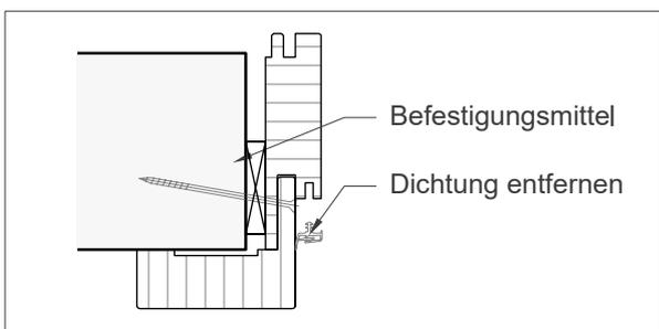
4. Hohlraum zwischen Wand und Zarge vollvolumig mit min. 1-K-PU Montageschaum (Brennbarkeitsklasse B2) ausschäumen bzw. mit Mineralwolle A1 stopfen.
