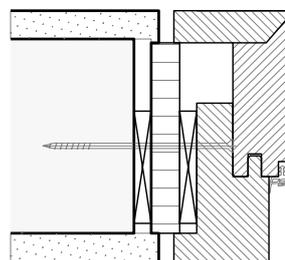
**Achtung:** Im Bereich der Befestigungspunkte muss druckfest hinterfütert werden (Klotzlänge ca. 100 mm).
