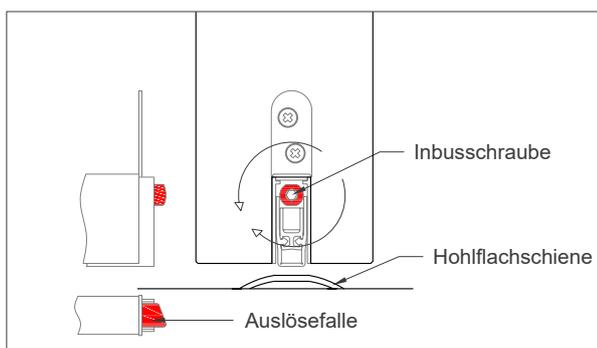
1. Bodenschliessmulde bei 2-flügeligen Türen montieren
